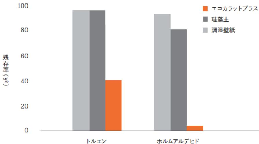
※ 試験結果は当社試験(各種VOCガスを入れた袋の中に試験体を設置し、初期と5時間経過後のガス濃度を測定)によるものです。部屋の使用条件、気象・換気などの環境条件によって異なります。
