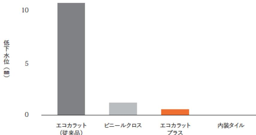
※ 試験体表面に直径35mmの試験管を立て、高さ200mmとなるよう注水し、1時間後の低下水位を測定しました。
