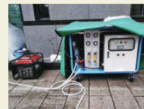
災害用浄水器と発電機のセットで 安心を確保（マンション等に設置）
