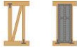
筋交い設置 構造用合板設置
